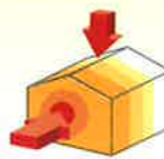
モノコック構造 外部からの荷重を面全体で分散し受け止めることで高い強度を発揮。
